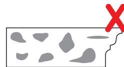
Nepravilno nanošenje cementnog lepka na fasadni profil
